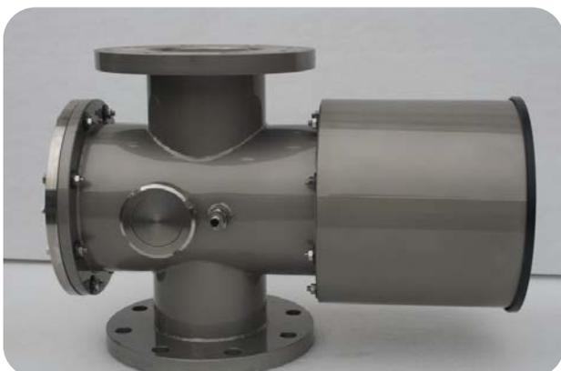
El uso de lámparas de alta intensidad Multibanda permite una importante reducción del tamaño del reactor ya sea por el menor número de lámparas (de 8 y 10 veces) como por su reducido tamaño, y disposición perpendicular al flujo. Todo ello permite una geometría muy compacta con el resultado final de equipos embridados en la línea de flujo, facilitando la aplicación y mejorando su fiabilidad.
